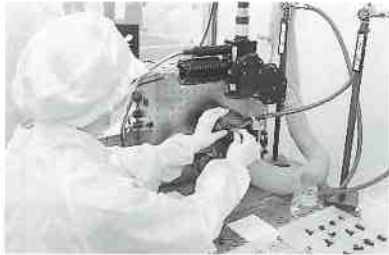
クリーンブース内（クラス1,000以下（実測値））にて、精密溶接、リークチェック、検査、梱包を一貫生産している。
